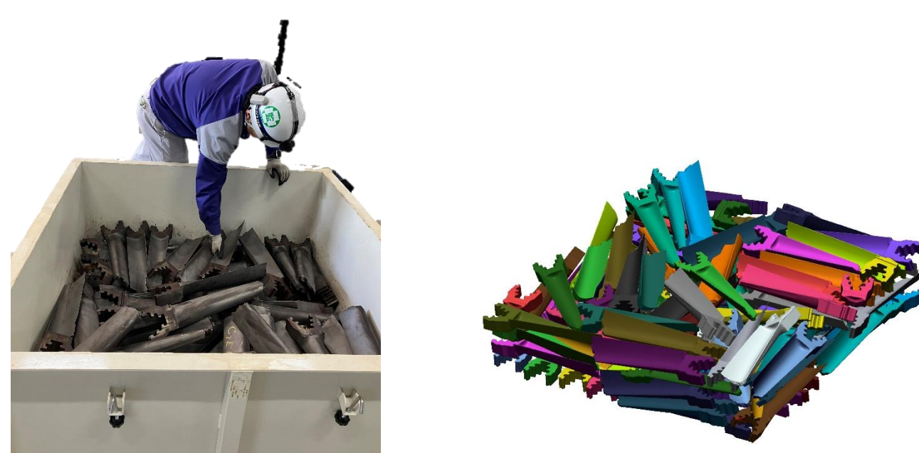
3Dスキャン結果をCAD上で再構成
