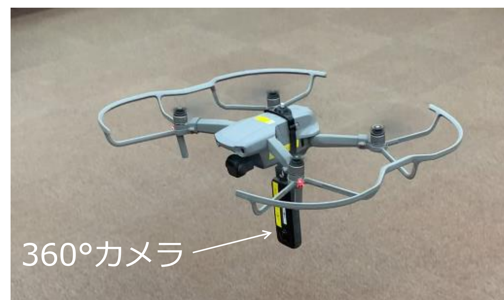
360°カメラを搭載したドローン
