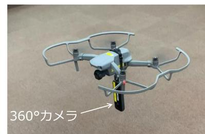
360°カメラを搭載したドローン
