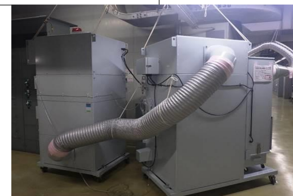
粉塵処理装置
