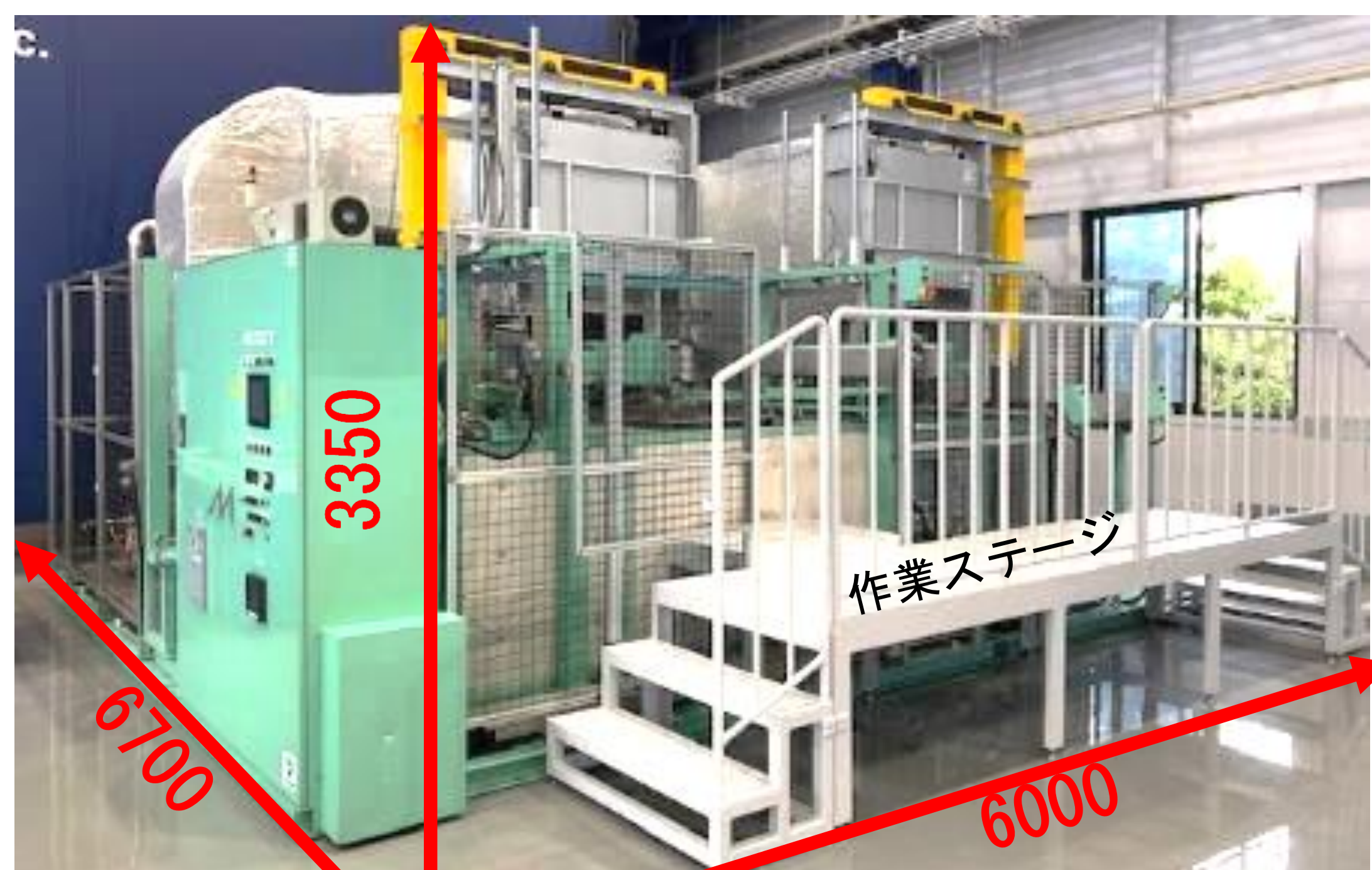
従来システム(アルミT6熱処理)の構成例 (6000×6700×3350mm)
