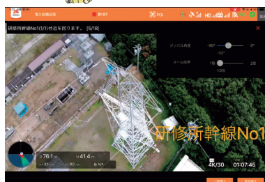
鉄塔外観の自動撮影
