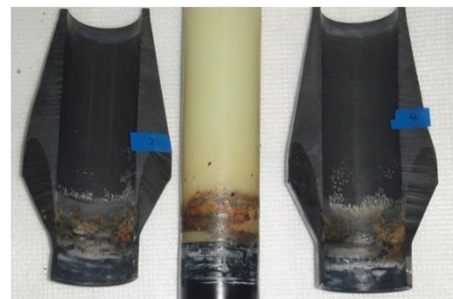
劣化度が高いと診断された端末の内部状態
