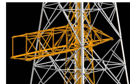
3次元現寸CADによる部材干渉検討
