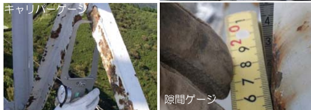
一般的な残存板厚測定としては、上記4手法があげられ、現地の設備環境や劣化状況から最善手法を選定し実施します。
