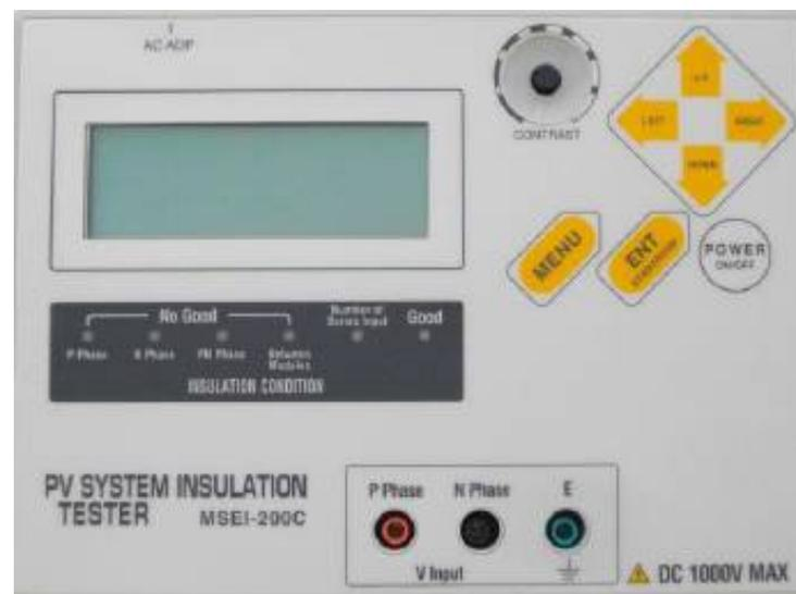
太陽光発電設備直流回路絶縁診断装置
