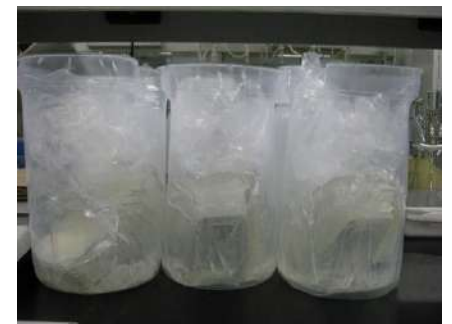
樹脂固化物塩溶出試験
