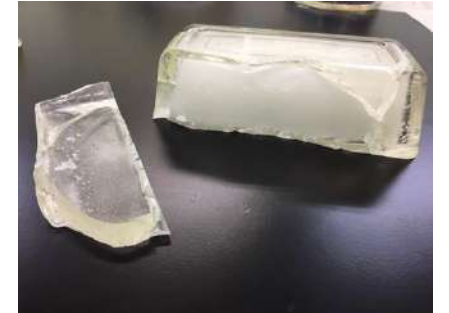
耐荷重試験時の様子 破断時の様子
