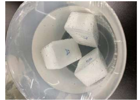
パラフィン固化物塩溶出試験
