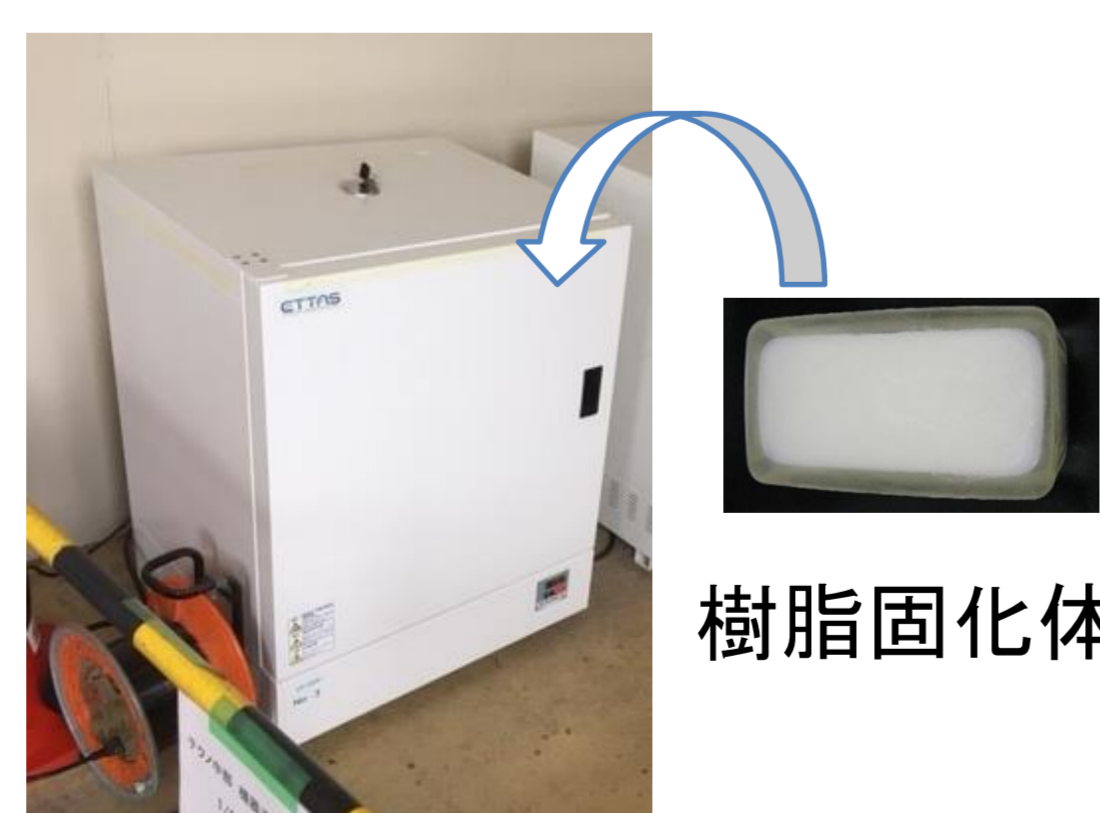
恒温槽による温度試験
