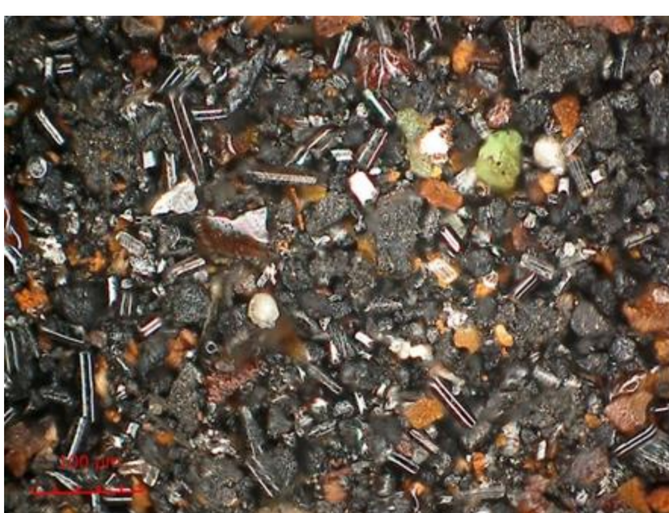
ガス圧縮機ストレーナ捕集物
