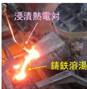
浸漬熱電対による鑄鉄溶湯の測温※
