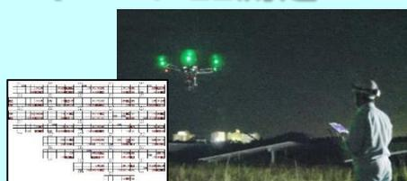
発電量低下の原因が熱画像測定でも分からない場合、PID現象が発生している可能性があります。その場合、簡易EL測定での検査をお勧めします。
