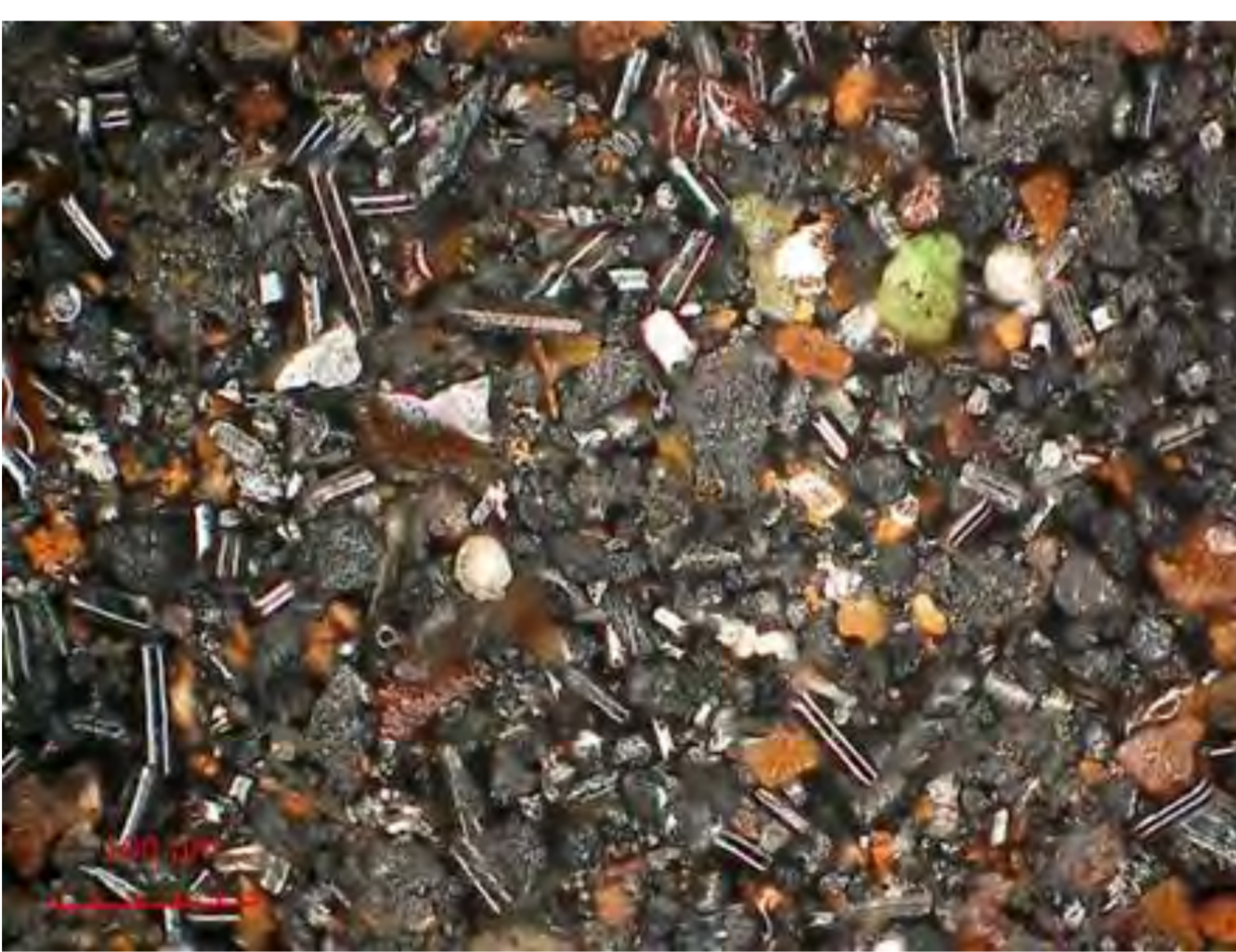
ガス圧縮機ストレーナ捕集物
