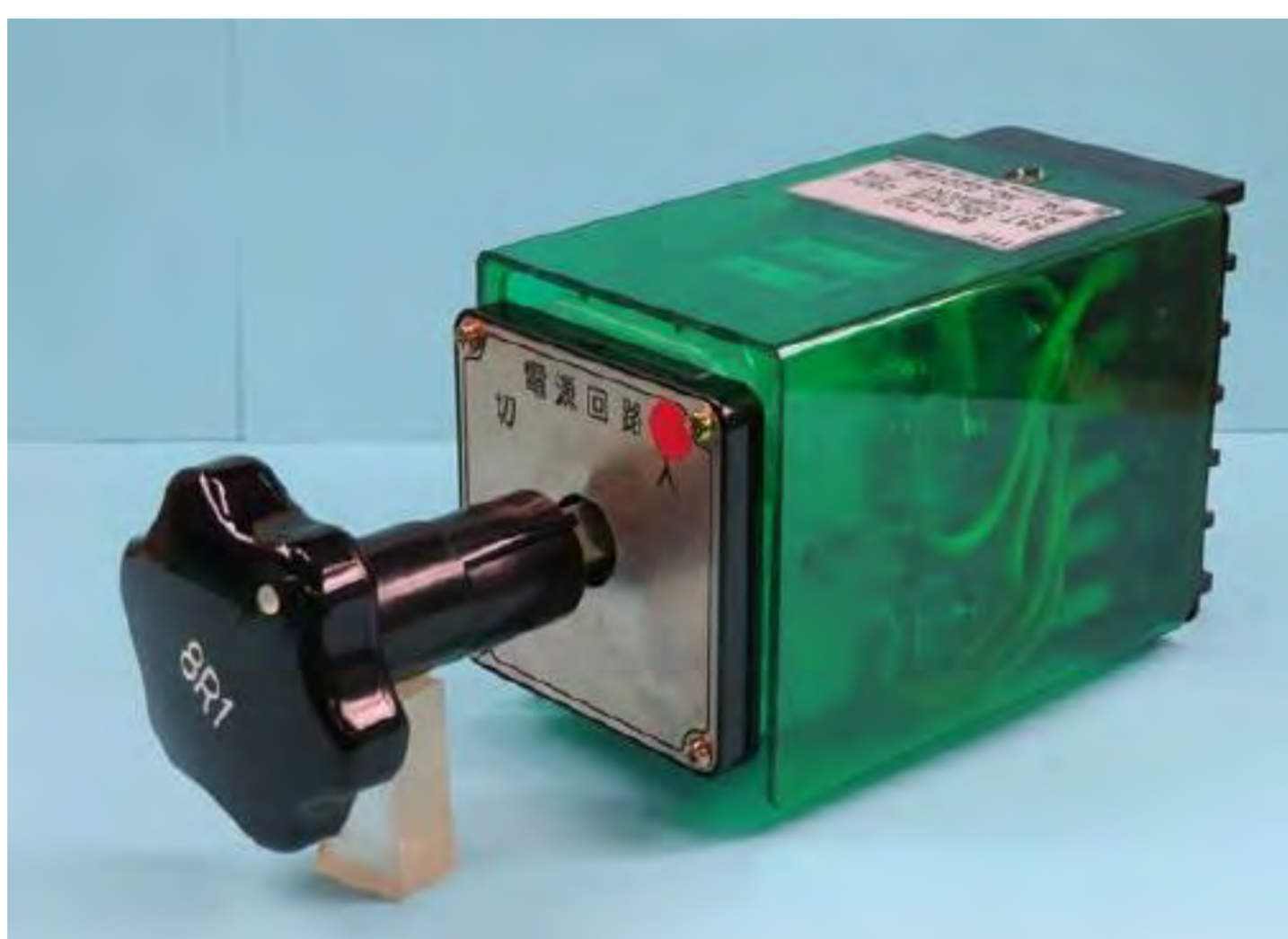
制御盤電源スイッチ接点不良調査
