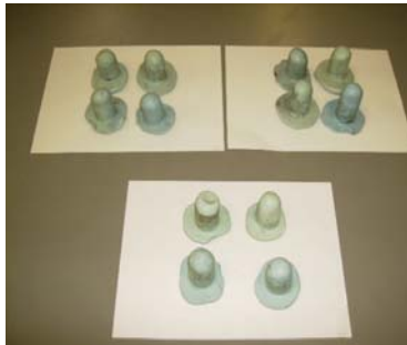
【圧カプレートの孔を型取りした樹脂】
