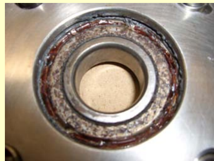
減速機構内部で確認された錆の状況
