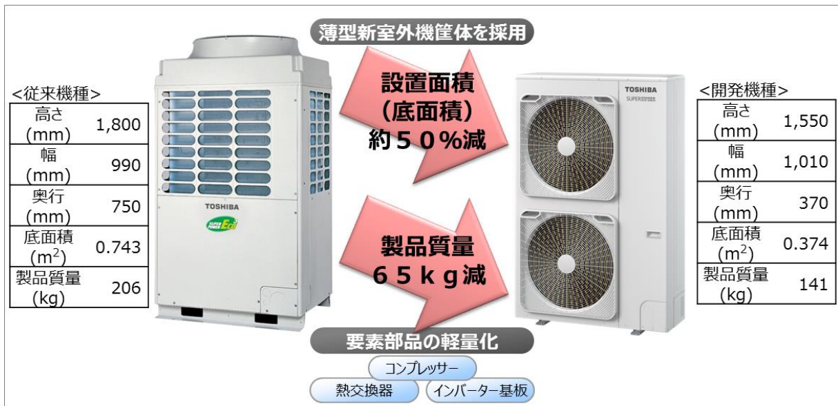
[図 5] 従来機種と開発機種との設置面積（底面積）・製品重量の比較
