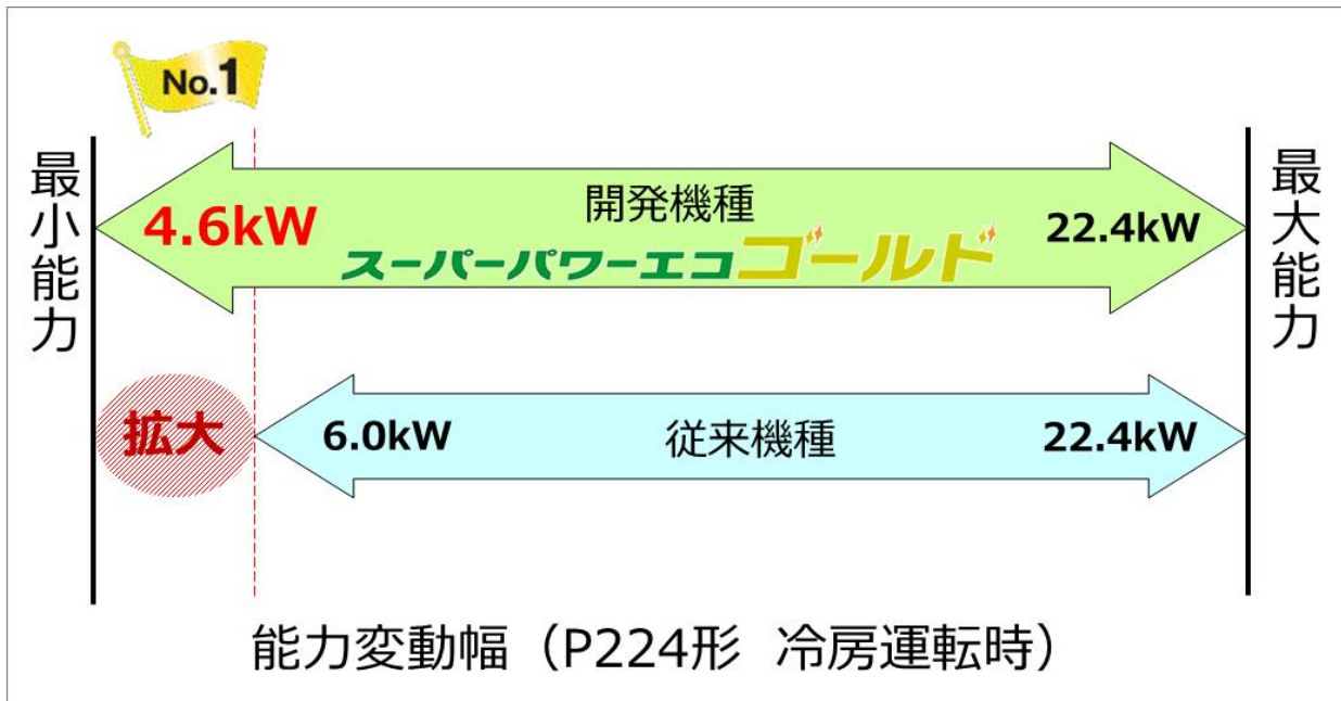
[図 3] 従来機種と開発機種との能力変動幅の比較
