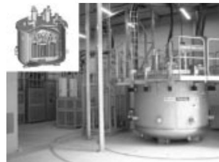
SMES(5000kW,1秒間補償)装置の実証試験(お客様工場にて試験中)
