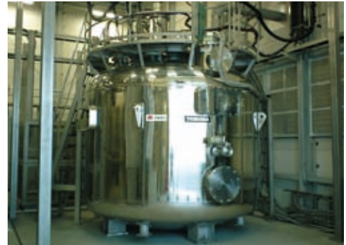
SMES (10,000kW 1秒間補償)装置の実証試験
