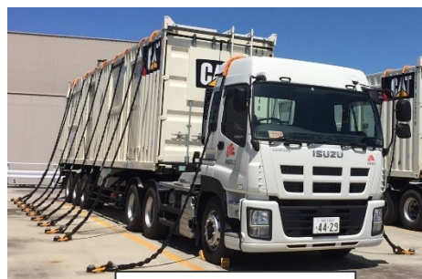
設備の固縛例
