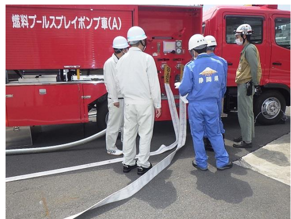
燃料プールスプレイポンプ車および 可搬ホースの点検の様子
