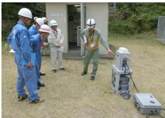
可搬型モニタリングポストの配備 点検の様子
