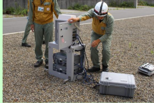
可搬型モニタリングポスト設置の様子
