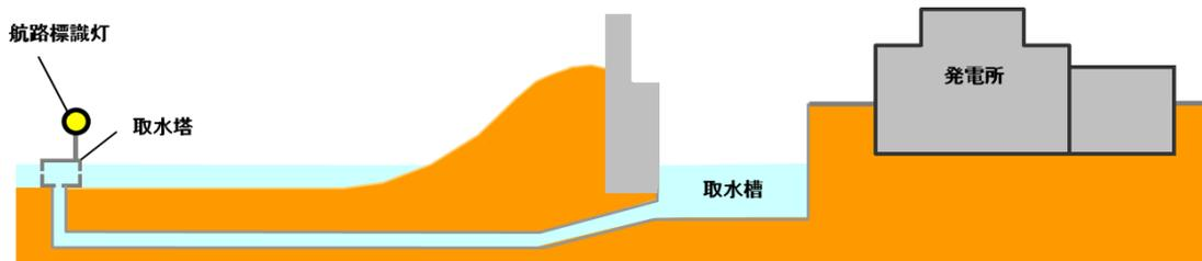
注1 取水塔は、蒸気タービン復水器冷却用水(海水)の取水のため、敷地前面の海岸沖に設置しています。
