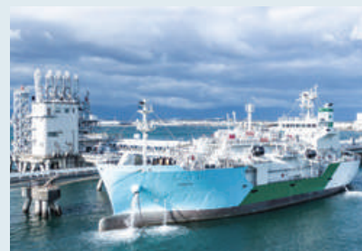
国内初となる 船から船への L N G 燃料の供給 (L N G バンカリング船 [かぐや])
