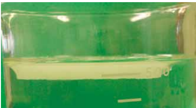
第3図 水面に存在する油膜の吸油状況
