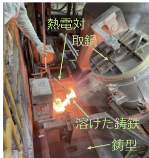
(c) 注湯工程
