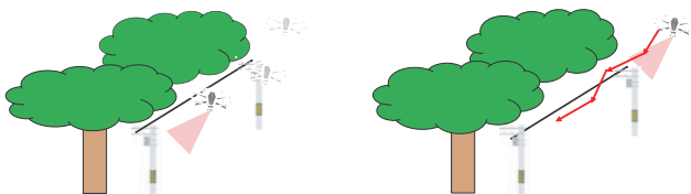
第1図 再現機能の概要（左：手動飛行の記録、右：再現飛行）
