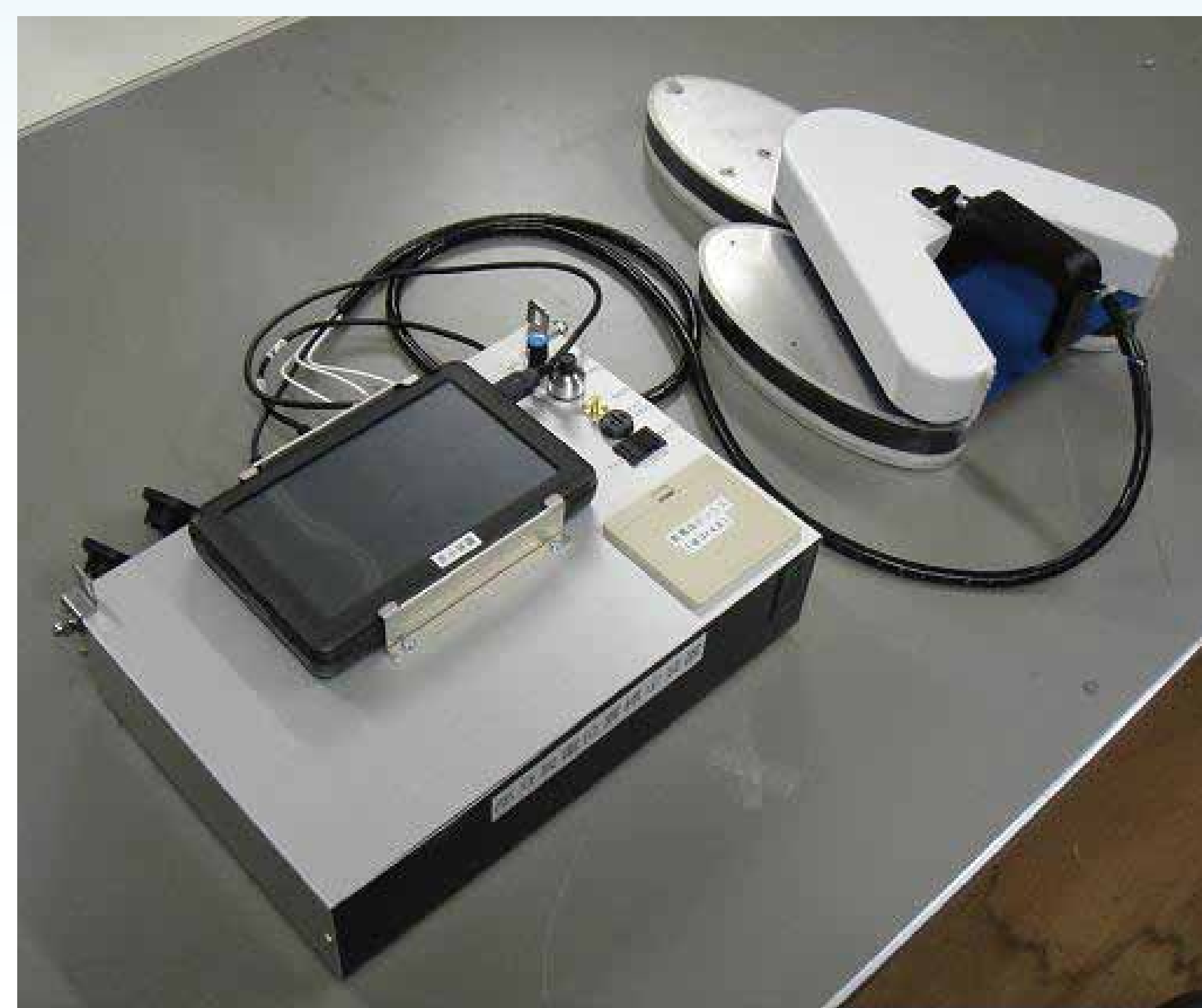
部分放電位置標定装置
