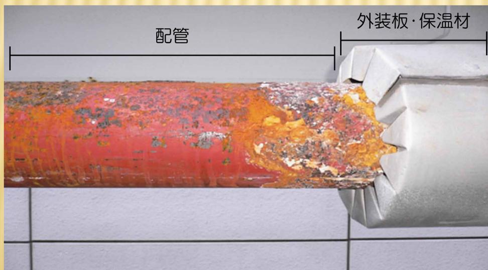
屋外配管の外面腐食事例
