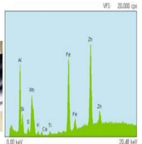
腐食した電線と腐食物のスペクトル
