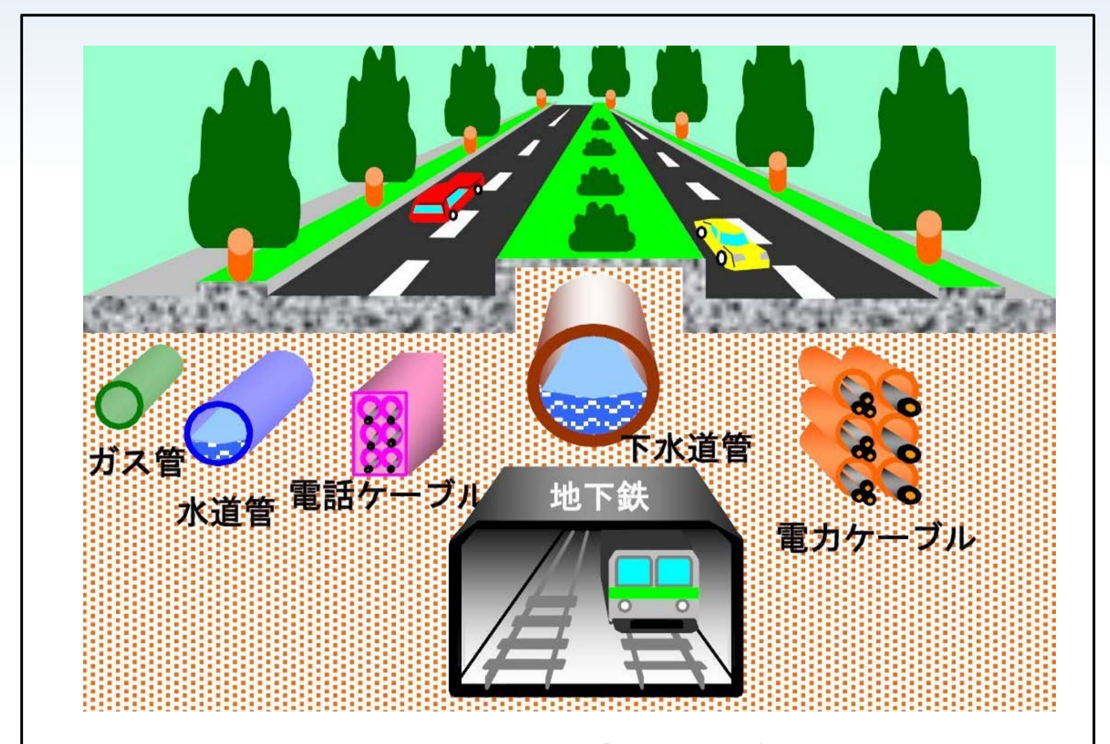
地下埋設物の様子
