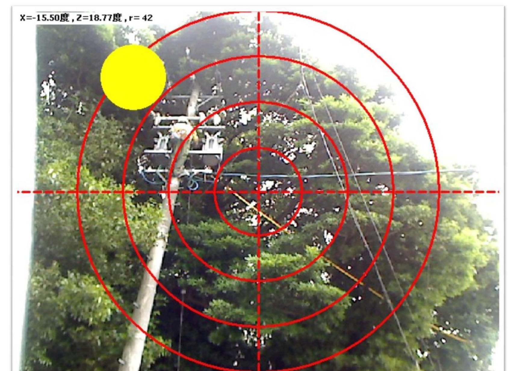
実フィールドでの標定例@豊橋営業所 風により樹木が高圧クランプ付近に接触した際に標定
