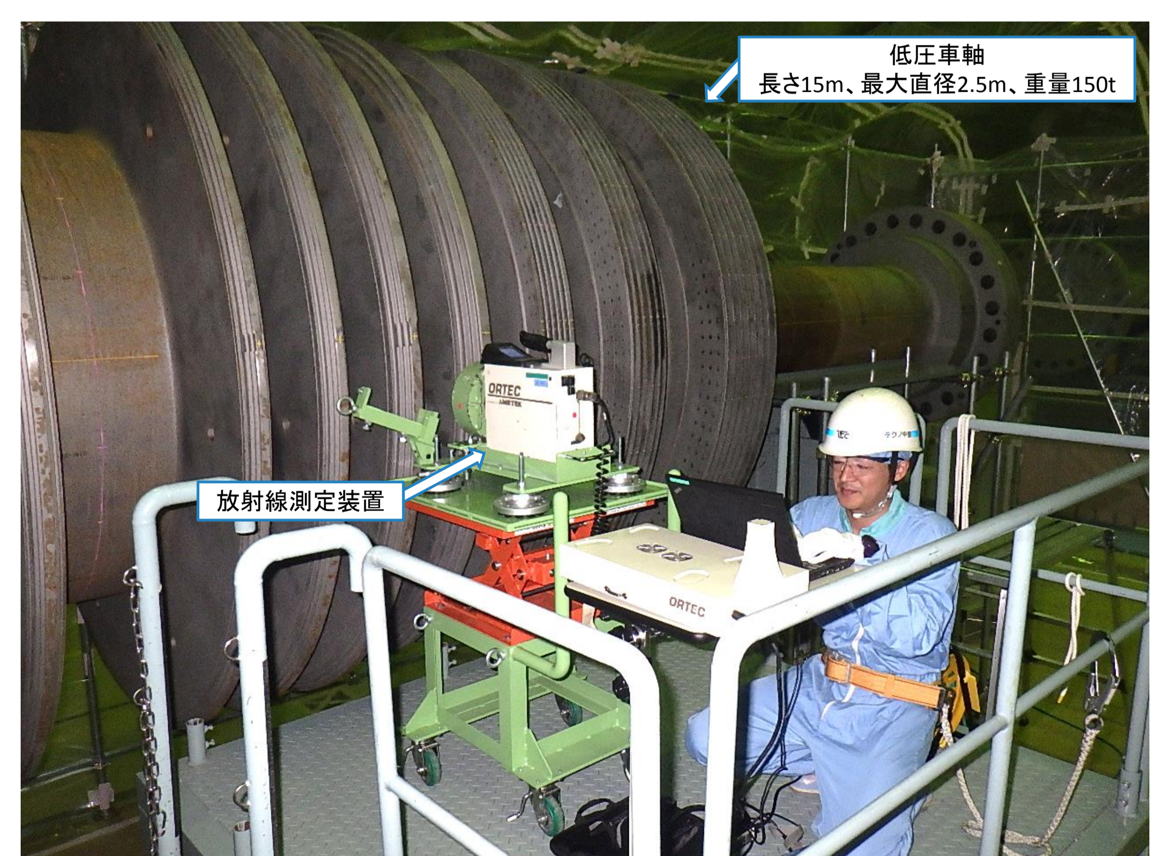
タービン低圧車軸のクリアランス測定
