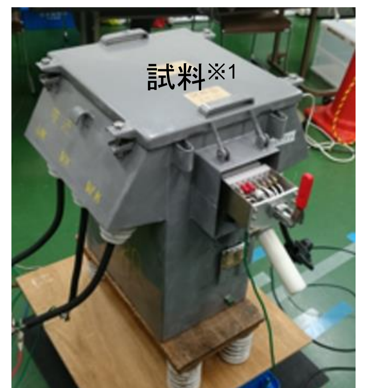
※1 試料には、計器用変圧変流器を用いた。
