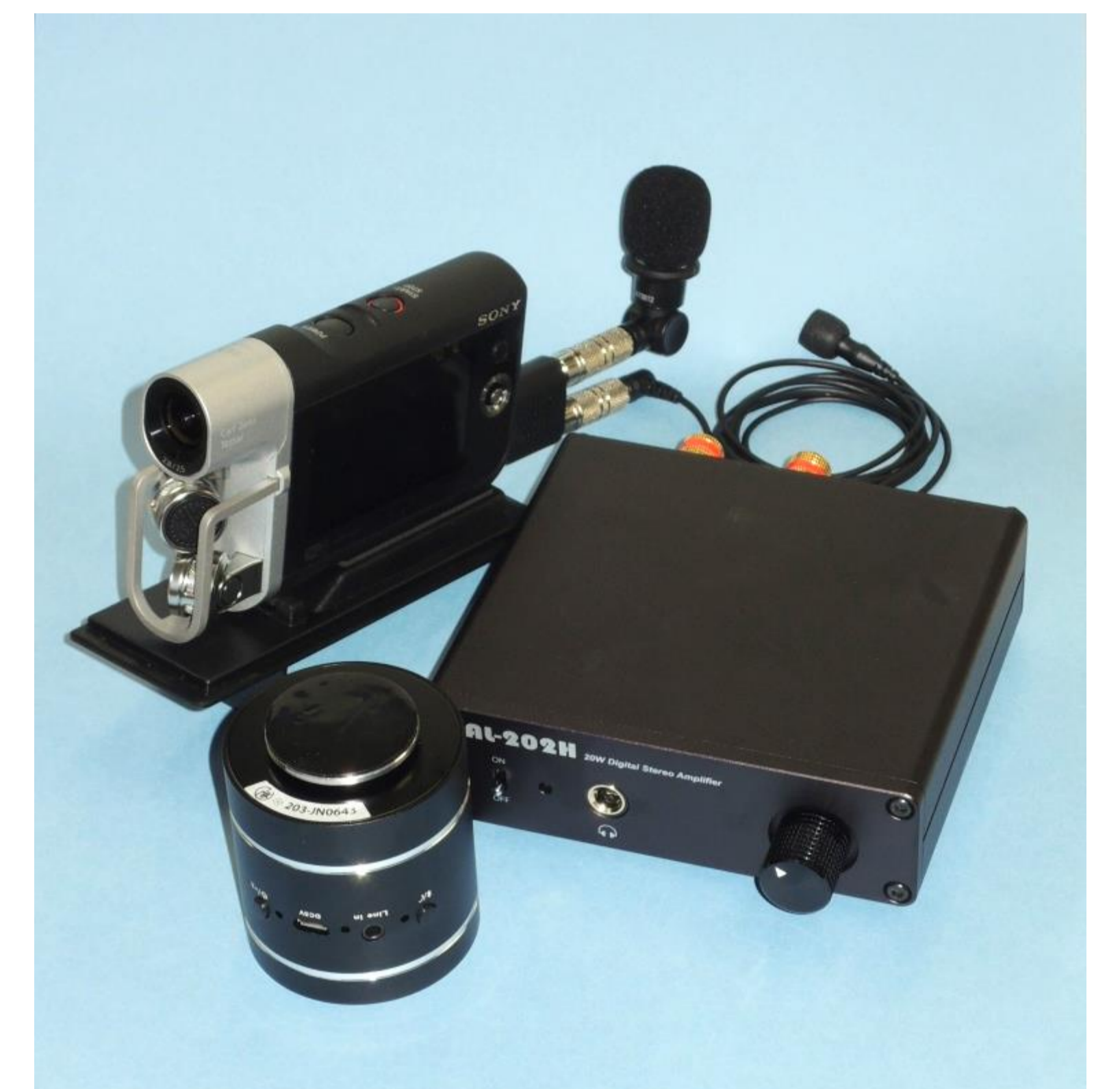
触感再現装置の例
