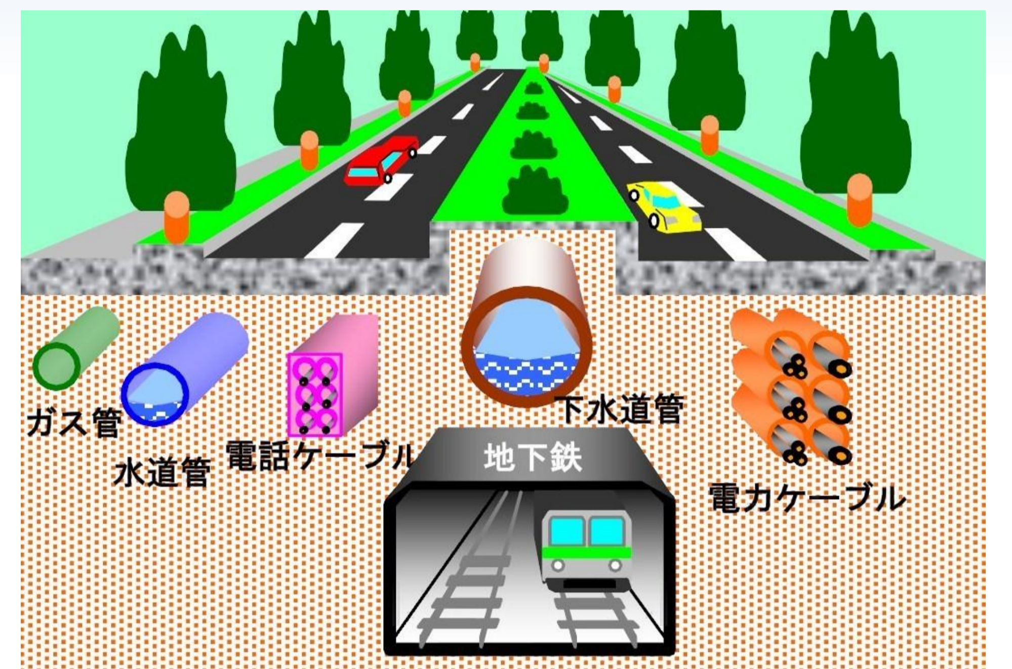
地下埋設物の様子
