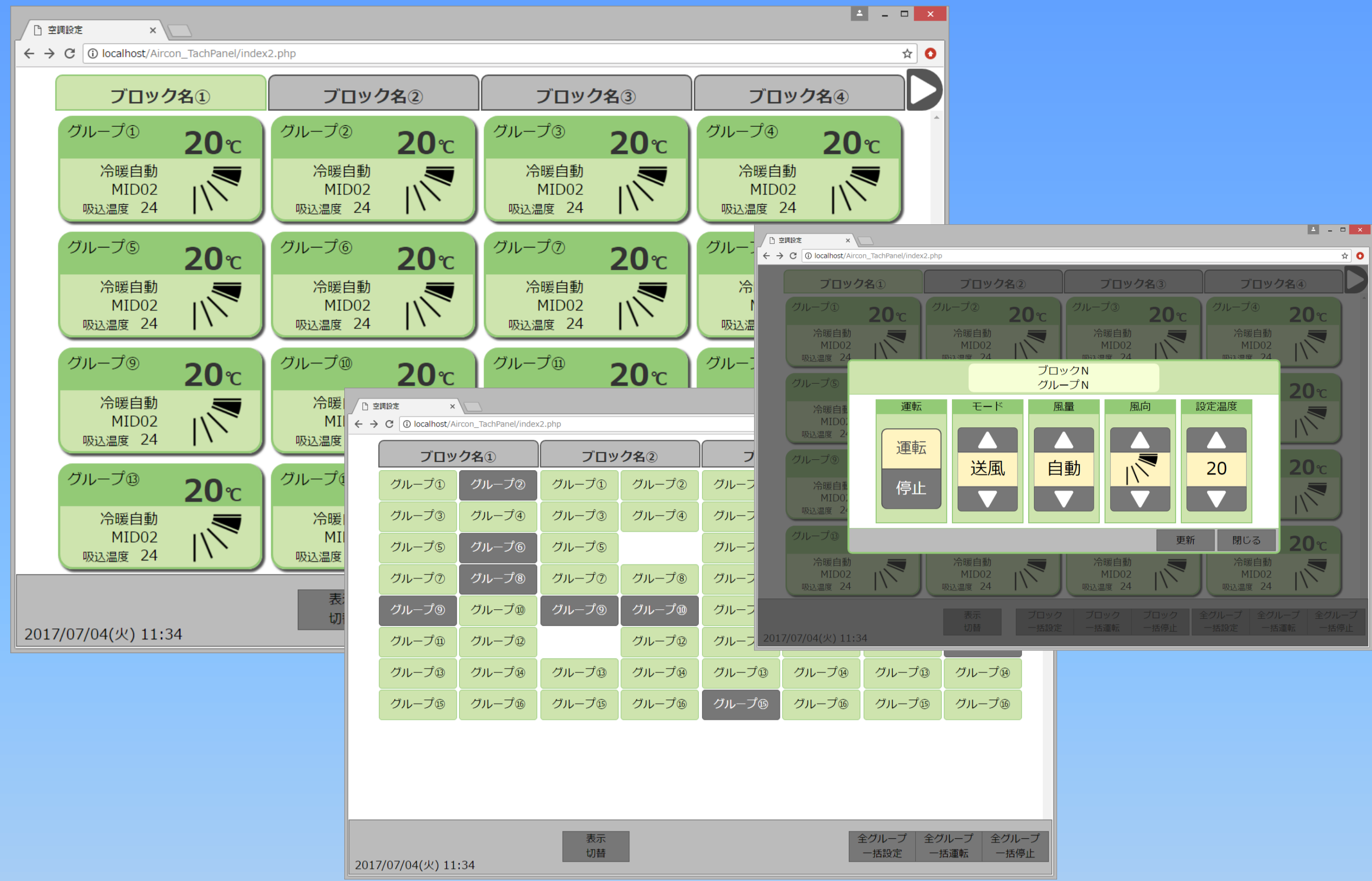
中電空調コントローラ 画面例
