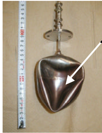
損傷していたフロート (低圧第3給水加熱器(A)ドレンレベルスイッチ)
