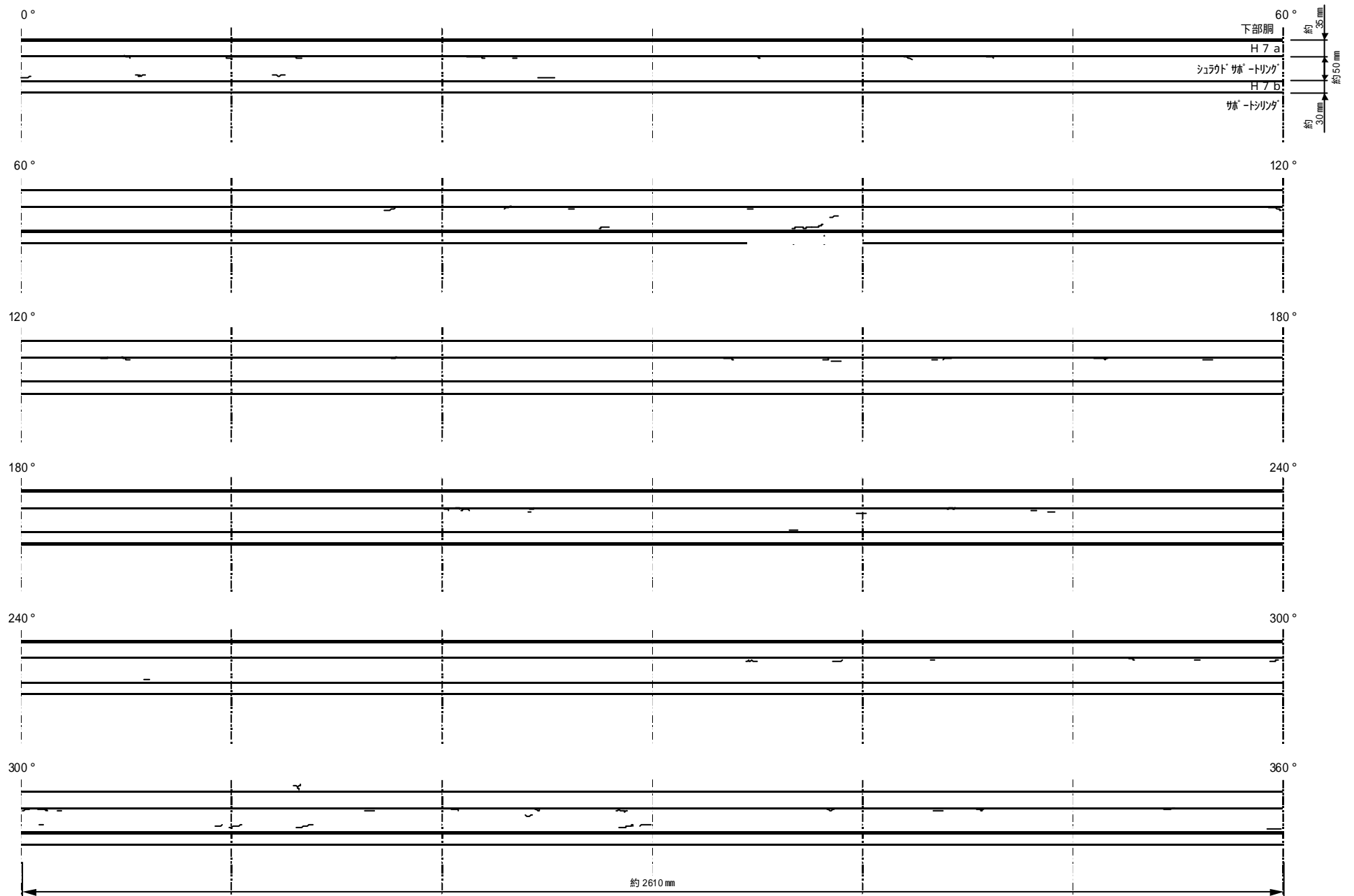
図5：シュラウドサポートリング内側溶接線（H7a,b内）付近目視点検結果
